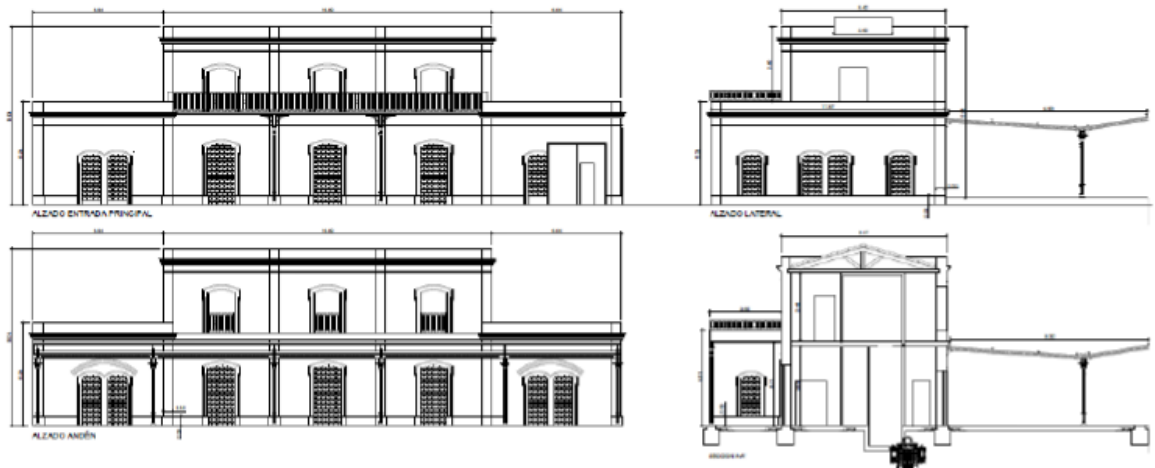
ALZADOS Y SECCIONES. ESTADO ACTUAL
